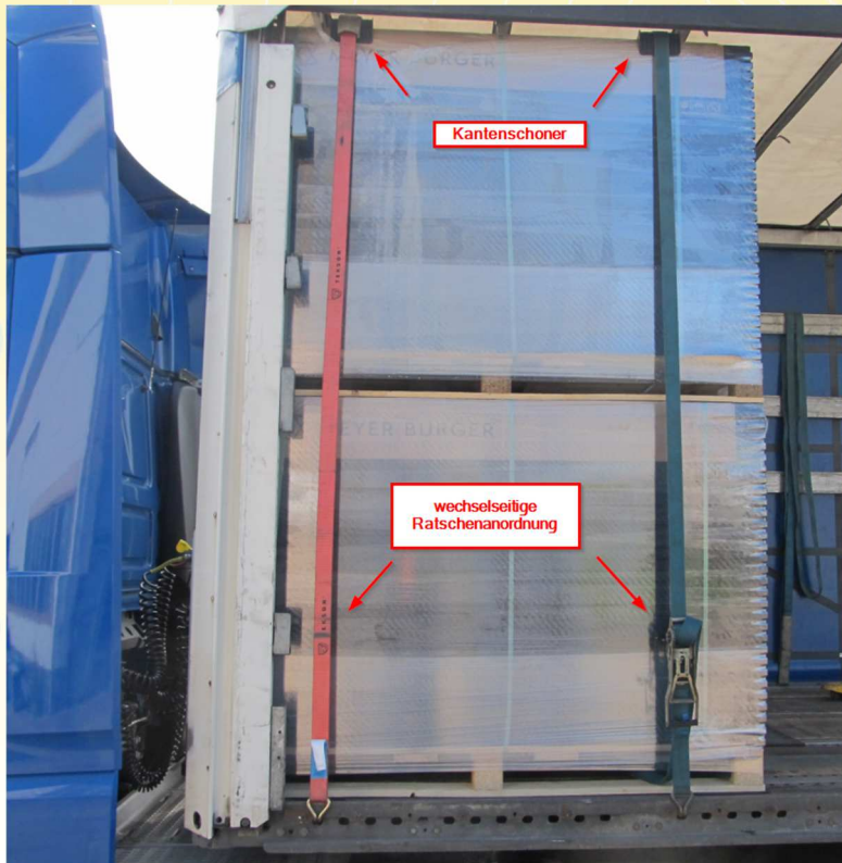
Foto: Sicherung einer Ladeeinheit (Zweifachstapelung) mit LC = 2.500 daN und STF = 500 daN, wechselseitige Ratschenanordnung. Absoluter Formschluss (Kontakt) zueinander in Längs- und Querrichtung. Absoluter Formschluss zur Stirnwand ist zwingend erforderlich. Stirnwand nach DIN EN 12642 Code XL.
