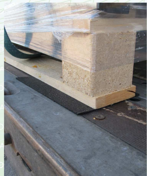
Foto: Sicherung einer Ladeeinheit (Zweifachstapelung) mit LC = 2.500 daN und STF = 500 daN, wechselseitige Ratschenanordnung. Absoluter Formschluss (Kontakt) zueinander in Längs- und Querrichtung. Absoluter Formschluss zur Stirnwand ist zwingend erforderlich. Stirnwand nach DIN EN 12642 Code XL.
