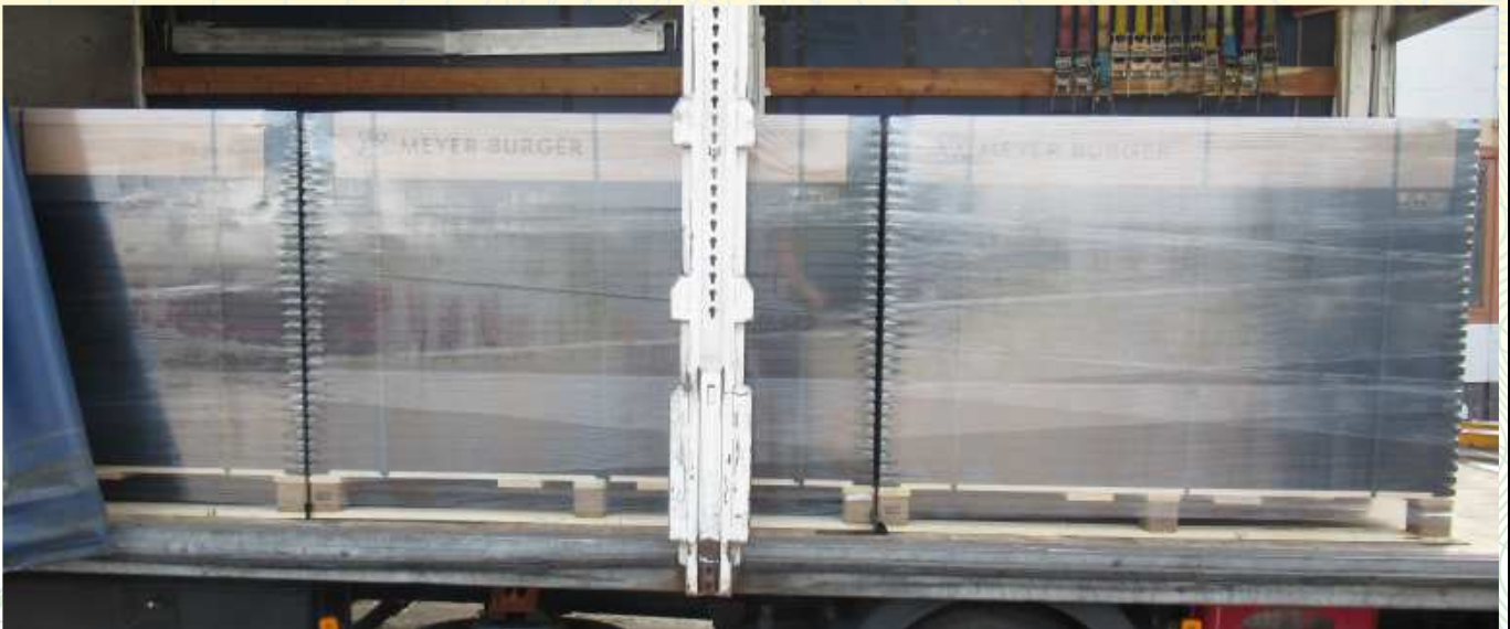
Foto: Solarmodule auf Spezialpaletten, längs in Fahrtrichtung
