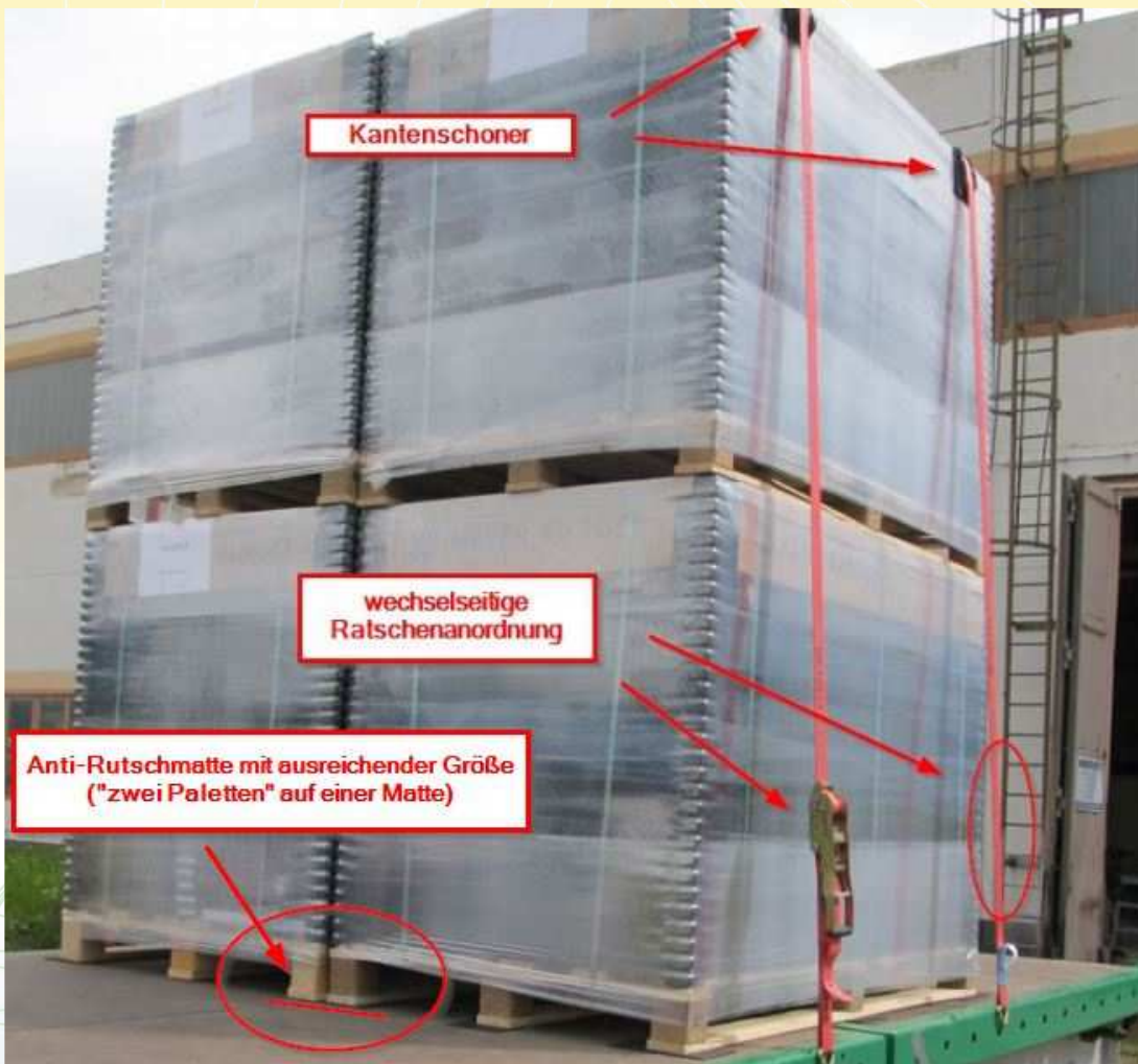
Foto: Sicherung einer Ladeeinheit (Zweifachstapelung) mit LC = 2.500 \text{ daN} und STF = 500 \text{ daN} , wechselseitige Ratschenanordnung. Absoluter Formschluss (Kontakt) zueinander in Längs- und Querrichtung. Mittige Anti-Rutschmatte mit ausreichender Größe, beide Paletten-Aufstandsflächen auf einer Anti-Rutschmatte.
