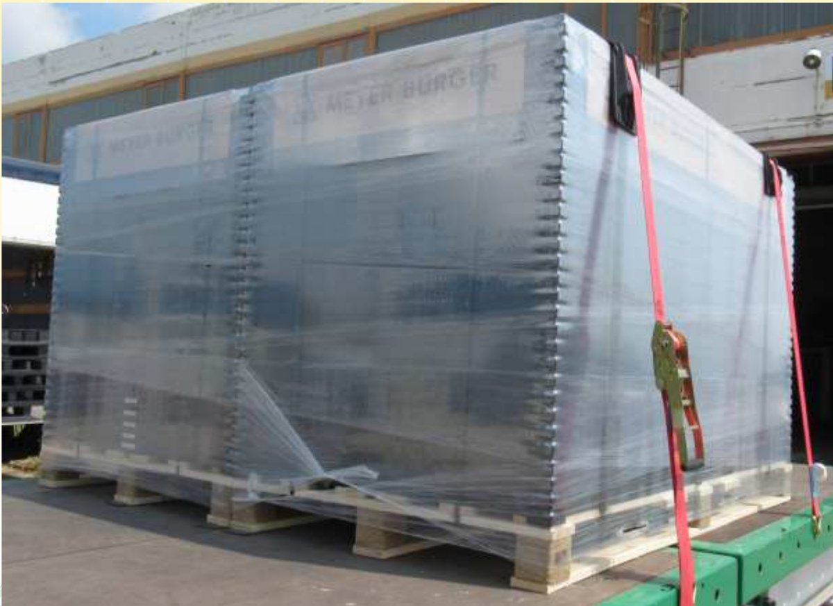
Foto: Sicherung einer Ladeinheit (Einfachstapelung) mit LC = 2.500 daN und STF = 500 daN, wechselseitige Ratschenanordnung. Absoluter Formschluss (Kontakt) zueinander.
