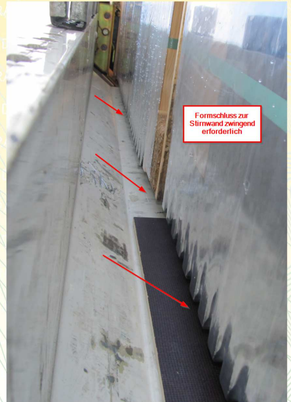
Foto: Sicherung einer Ladeeinheit (Zweifachstapelung) mit LC = 2.500 daN und STF = 500 daN, wechselseitige Ratschenanordnung. Absoluter Formschluss (Kontakt) zueinander in Längs- und Querrichtung. Absoluter Formschluss zur Stirnwand ist zwingend erforderlich. Stirnwand nach DIN EN 12642 Code XL.
